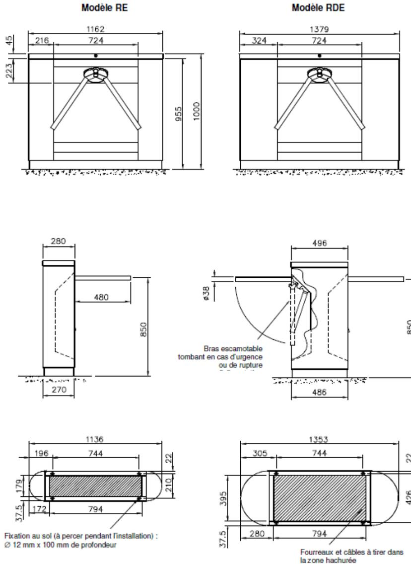
Le sol doit être plat et de niveau  $\pm 5$  mm sur la zone d'installation de l'équipement.
