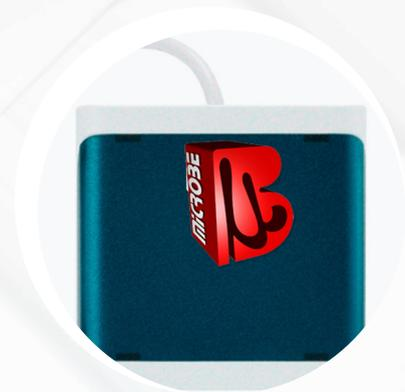
Le lecteur FP153A USB permet la lecture et la programmation des cartes à puce sans contact Mifare (13,56 MHz), en association avec les logiciels Micro Be tels que Saxo, ScolaWin, Diapason et les modules DDE. Connexion directe à un ordinateur via liaison USB.
